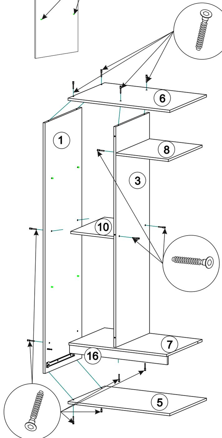
Монтаж эксцентриковой стяжки
