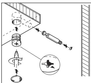
4. К собранной конструкции присоедините боковину №2 и соедините ее при помощи евровинтов с вязками №7 и 8, дном №5 и крышкой №6. С помощью эксцентриковой стяжки закрепите планку №15 со стойкой №3 с боковиной №2 и планку №16 со стойкой №3. На дно №5 шурупами 4x30 приверните опоры ОСК-20К.
